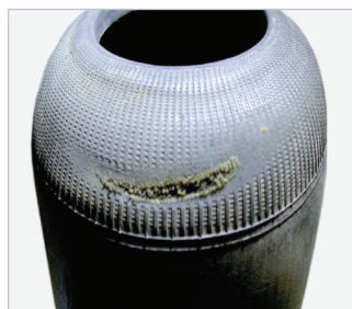
Obr. 4: Odřená napodobenina měchu vzduchového pérování
